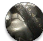
Cadena de tiempo de una motocicleta Honda 500cc inspeccionada con el Hawkeye Pro Flexible
